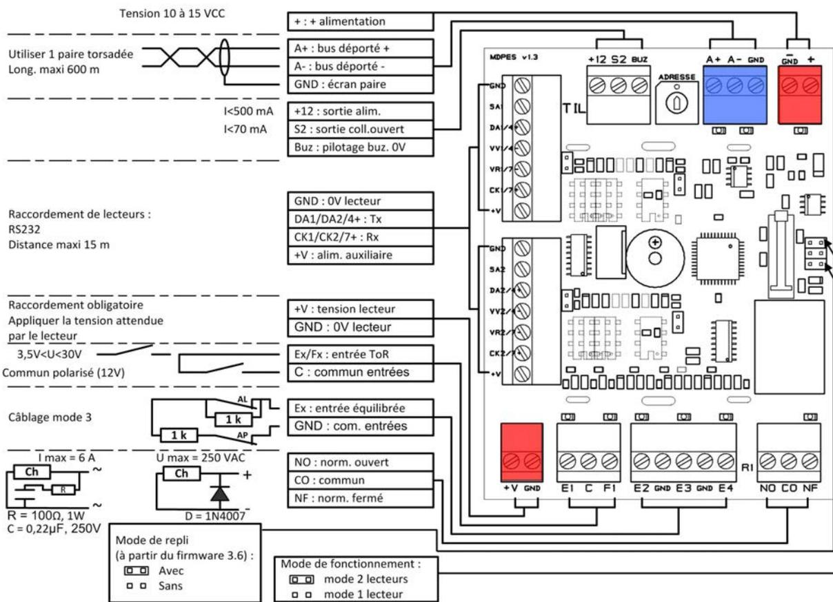
En mode de repli, le relais de commande est alimenté dès que le module est sous tension et le bus correctement raccordé à l'UTL. Assurer la connexion du mécanisme de verrouillage en sécurité positive en câblant l'équipement entre les bornes CO et NO du relais. **Les lecteurs raccordés sur ce module doivent être de technologie identique.**
